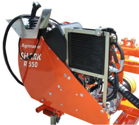
Värmeväxlare med elfläkt
